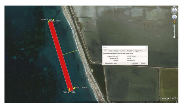
Vérification de la largeur du brise-lames sur Google Earth = 30 mètres (à 145 m.du littoral à l'ouest du pied du brise-lames)
